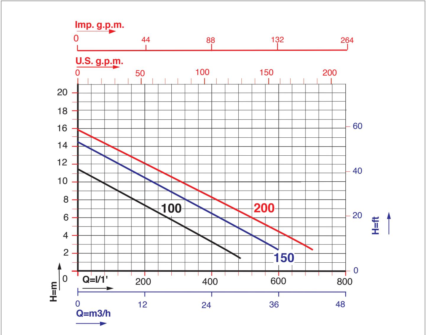
Caratteristiche di funzionamento a 2800 rpm 50Hz e 3450 rpm 60Hz - Performances at 2800 rpm 50 Hz and 3450 rpm 60 Hz
